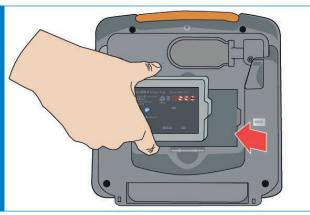
Rangez maintenant l'électrode au dos de l'AED, dans le compartiment prévu à cet effet.
