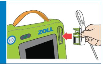
Retirez la pile, attendez 30 secondes, insérez la nouvelle pile et appuyez fermement pour que les deux parties à encliqueter s'emboîtent.
